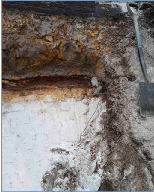
Ausschnitt aus der Geologische Schichtenfolge in der Breniger Grube: weißer Quarzsand, darüber Wechsel aus Braunkohle und Ton
